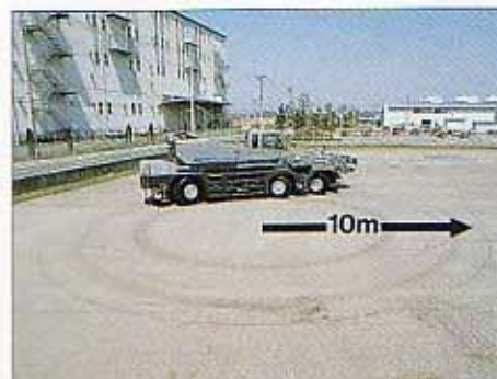
●50tクラスより小さな最小回転半径10m(一般走行時)
