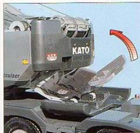
●独特な「回転リフト方式」のカウンターウエイト着脱機構
